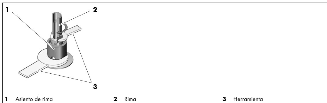
Fig. 12 Montaje de la rima
